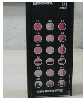
標準比色液と比較して残留塩素量を求める
