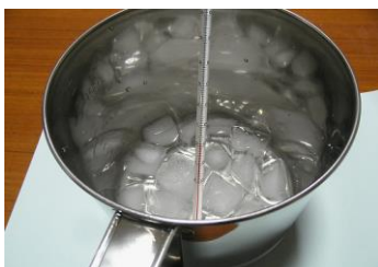
氷200gに水100mlを入れてよくかき混ぜ、0℃の氷水を作成する
