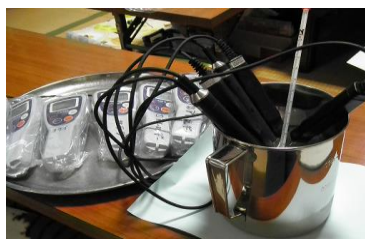
棒状温度計と、点検する温度計とを一緒に入れ、表示された値を比較して正確かどうかを点検する
