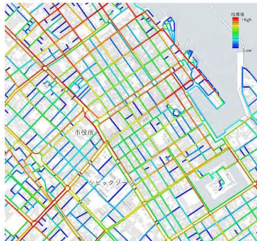
③ 途中経路としての通り掛かりやすさ - 媒介中心性 - 解析範囲: 800m 動線モデルをベースとして、800m圏内に含まれる任意の2地点間の最適経路を総当たりで計算し、その途中経路として選ばれた回数を単位空間（街路セグメント）ごとに集計して指標化。値が高い（赤系）ほど、800m圏内での移動の際に途中経路として利用される可能性が高い。
