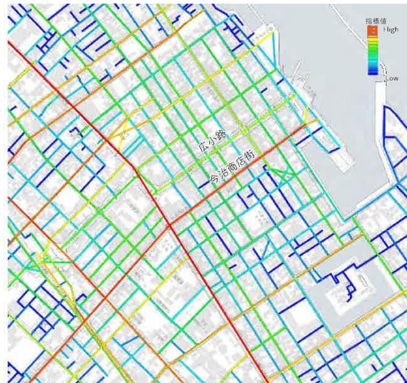
① 認知的つながりの良さ - 近接中心性 - 解析範囲 R4 (累計屈折角度=360°) 街路空間において「見える」範囲を、ひとつの空間として1本の軸線で表現した「認知モデル」。人々がその街の構造をどのように認知しているのかを知るために、これらの軸線相互の接続関係グラフ理論を用いて指標化。値が高い（赤系）ほど、「表通り」的に認知されやすい。
