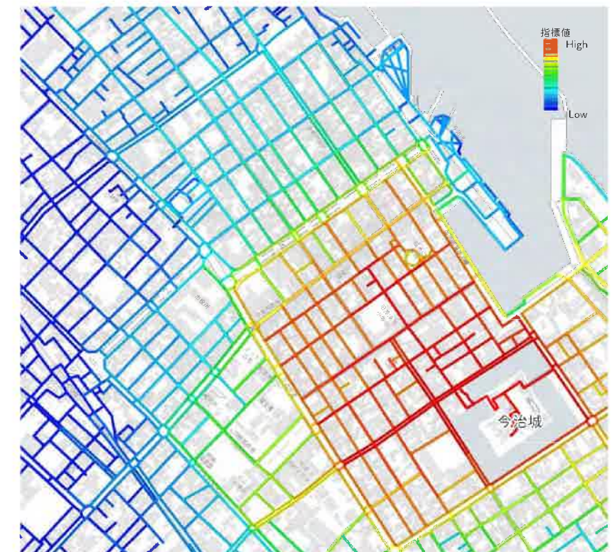
④ 今治城からの近接感 < 距離 + 屈折の統合指標 > 動線モデルをベースとして、主要施設からの人が感じる「近さ・遠さ」を、物理的な距離（メートル単位）と認知的な距離（屈折角度の累計）のそれぞれでデータ化し、それらを合成して指標化。値が高い（赤系）ほど、主要施設から近く感じる場所となっている。
