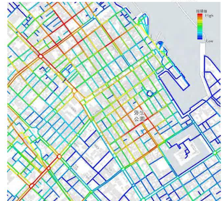
② 動線的つながりの良さ - 近接中心性 - 解析範囲 400m 直接歩いて「行ける」範囲を一つの空間のまとまりとして、1本の線で表現した「動線モデル」。グラフ理論における近接中心性によって指標化。人の活動の多さとの相関があるとされており、値が高い（赤系）ほど、動線的なつながりが高く、人の活動が集まりやすい。
