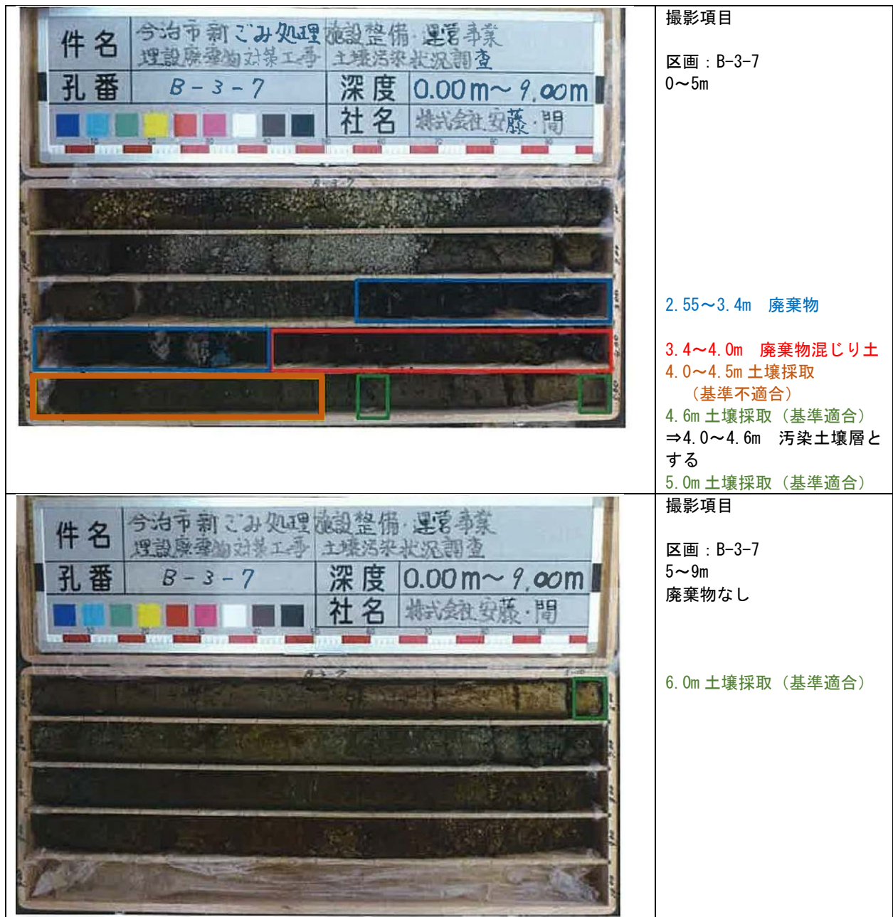
写真 6.7-1 土壌汚染状況調査（詳細調査）に基づく廃棄物及び廃棄物混じり土、並びに汚染土壌等の区分
