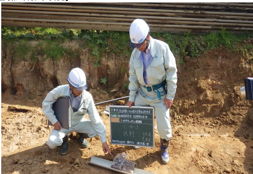
写真 6.7-3 埋め戻し完了後の地下水及び表層土壌調査状況
