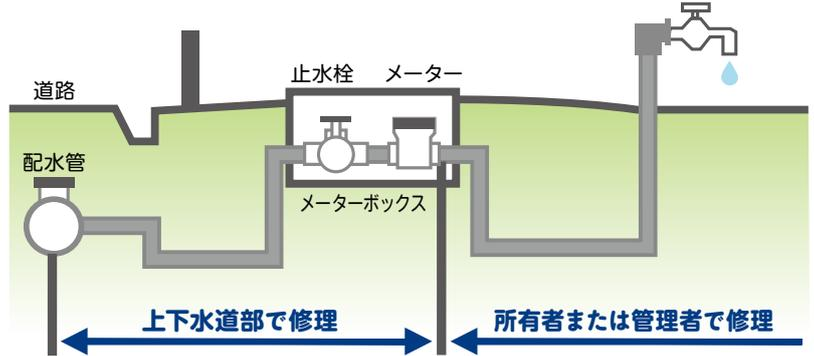
水道の配水管から分岐して家庭に引き込まれた給水管、これに取り付けてある止水栓、水道メーター、蛇口などを「給水装置」といいます。メーター以外のものは「建物の所有者の財産」です。日頃から点検・管理を心掛けましょう。
