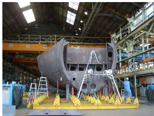
船体ブロック加工工場 (例)
