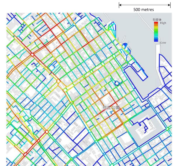
② 動線的つながりの良さ - 近接中心性 - 解析範囲 400m 直接歩いて「行ける」範囲を一つの空間のまとまりとして、1本の線で表現した「動線モデル」。グラフ理論における近接中心性によって指標化。人の活動の多さとの相関があるとされており、値が高い（赤系）ほど、動線的なつながりが良く、人の活動が集まりやすい。
