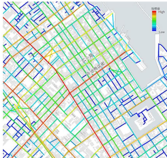
① 認知的つながりの良さ - 近接中心性 - 解析範囲 R4 (累計屈折角度=360°) 1本の道として認識される街路空間の「全幅」に対して1本（歩車道を区別せずに）中心線を連続的に引いた「認知モデル」。人々がその街の構造をどのように認知しているのかを知るために、これらの軸線（線分）相互の接続関係グラフ理論を用いて指標化。値が高い（赤系）ほど、「表通り」的に認知されやすい。
