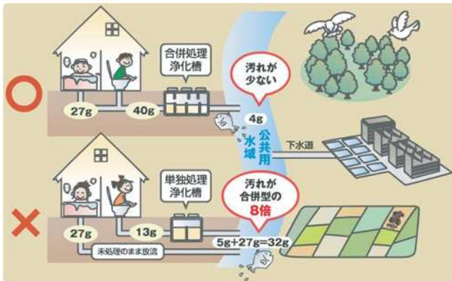
（出典：環境省 HP） 図 4 合併処理浄化槽排水の概略図及び水質改善効果
